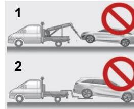
Advertência: não reboque com equipamento tipo eslinga (1). Não reboque o veículo com as rodas dianteiras no chão, uma vez que isso pode causar danos no veículo (2).
