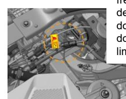
O bloqueador de serviço está localizado à frente da caixa de fusíveis, perto do reservatório do líquido do limpador de vidros.
