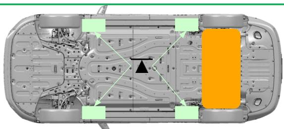
Para estabilizar o veículo, apoie-o em quatro pontos diretamente sob os pilares dianteiros e traseiros, utilizando blocos de madeira ou objetos equivalentes.
