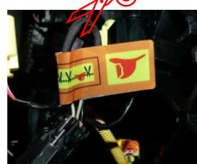
Corte o cabo do bloqueador de serviço para desativar o sistema de AT
